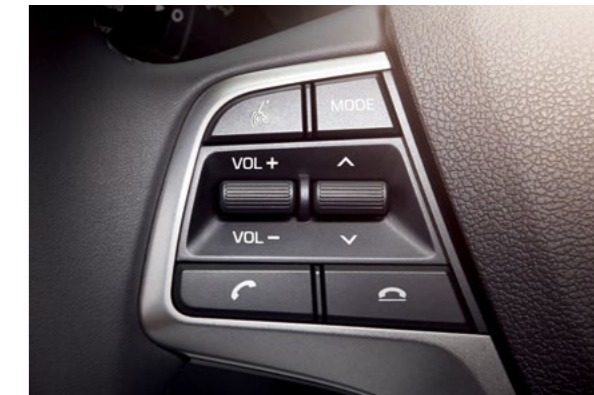
Sistema de audio con control remoto
