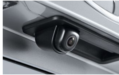
Cámara de retroceso
